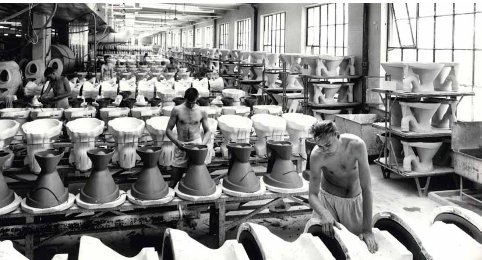
Gjutsalen i sanitetsgodsfabriken. Odaterat foto taget av Bertil Edstrand. Skånska Cement-koncernens fotosamling.
